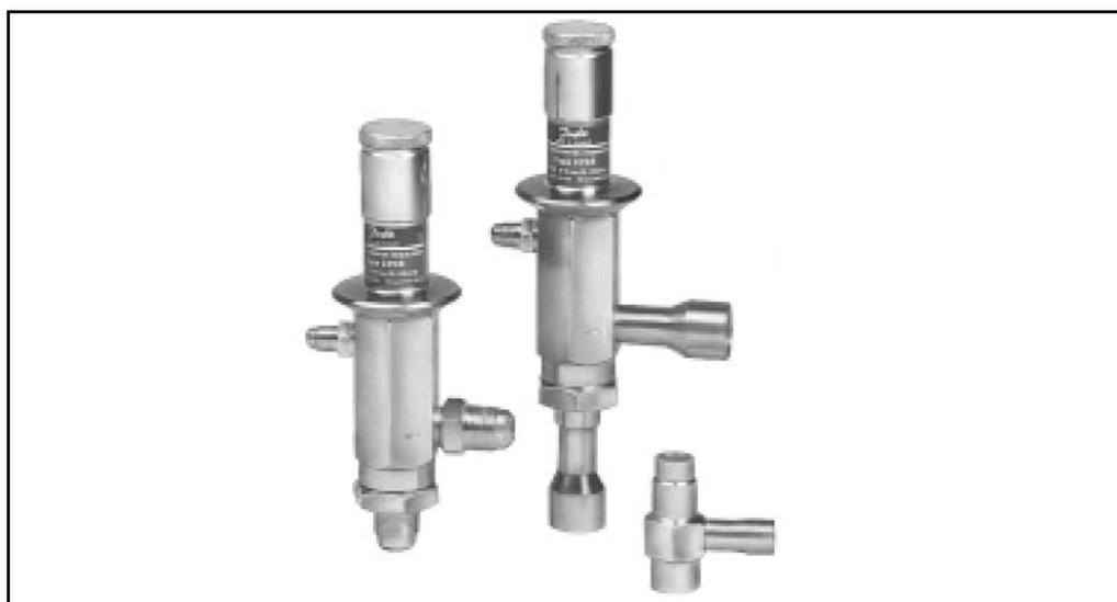
Регуляторы производительности CPCE применяются для приведения производительности компрессора в соответствие с фактической нагрузкой испарителя. CPCE монтируется в байпасной линии между сторонами низкого и высокого давлений холо-
